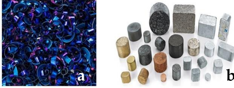
Şekil 1. Talaş; (a) endüstriyel atık talaş ve (b) briket haline getirilmiş talaş [19]
